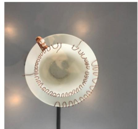
Figure 5. Tasse avec les capteurs capacitifs
